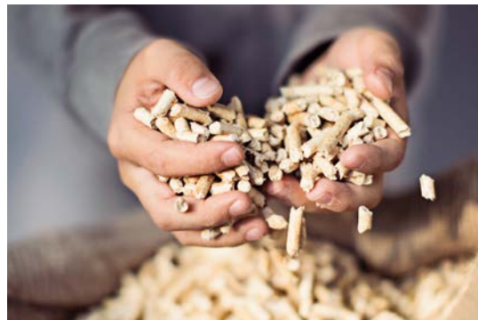
Sägereststoffe (Rinde, Sägespäne) werden getrocknet, zerkleinert und dann mit hohem Druck gepresst.
