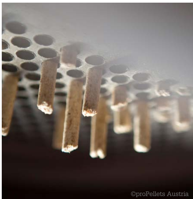
Hier ist der Austritt der Holzpresslinge aus der Matrize zu sehen.
