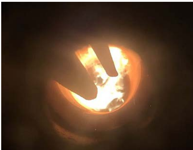
Normale Verfeuerung der Pellets - inkl. Flamme
