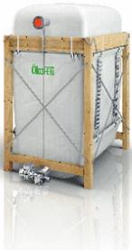
Der Gewebetank mit Zugfedern Flexilo Compact ermöglicht die maximale Raumnutzung. Der Tank besteht aus hochwertigem Polyestergewebe, ist staubdicht, aber luftdurchlässig, dauerhaft antistatisch und einfach in der Montage. Das Gewebe liegt auf dem Boden auf. Eine Austragungsschnecke dient als Entnahmeeinheit. Die seitliche Aufhängung an Federn ermöglicht die Entleerung zur Gänze. ÖkoFEN Gewebetanks sind nur in Verbindung mit einer Kesselanlage erhältlich.
