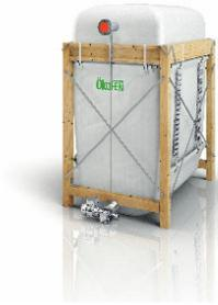
Der Gewebetank mit Zugfedern Flexilo Compact ermöglicht die maximale Raumnutzung. Der Tank besteht aus hochwertigem Polyestergewebe, ist staubdicht, aber luftdurchlässig, dauerhaft antistatisch und einfach in der Montage. Das Gewebe liegt auf dem Boden auf. Eine Austragungsschnecke dient als Entnahmeeinheit. Die seitliche Aufhängung an Federn ermöglicht die Entleerung zur Gänze. ÖkoFEN Gewebetanks sind nur in Verbindung mit einer Kesselanlage erhältlich.
